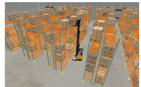
Estanterías de paletización convencional, pasillos estrechos, estantes mixtos
