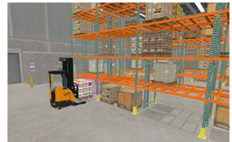
Estanterías de paletización convencional, pasillos estándar, estantes bajos
