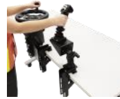
Interface de commande réplique (2 choix pour l'orientation du joystick)
