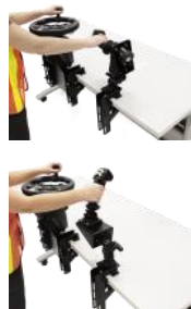
Interface de commande réplique (2 choix pour l'orientation du joystick)
