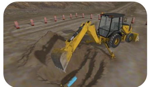
Exponiendo un conducto subterráneo con cuchara de excavadora
