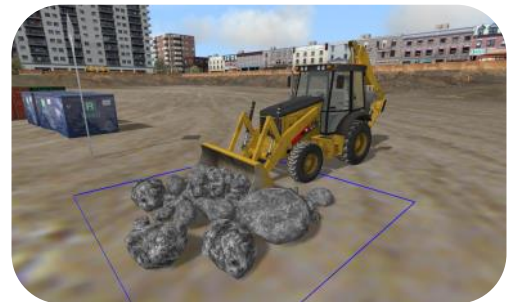
Descargano piedras en zona de descarga con cuchara de cargador
