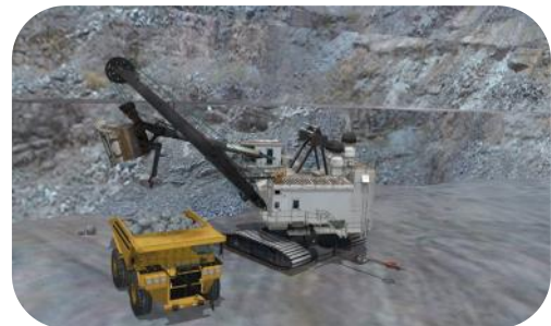
Posicionamiento del camión para ser cargado por la pala interactiva
