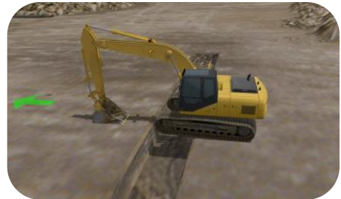
Atravesando una zanja utilizando la pluma
